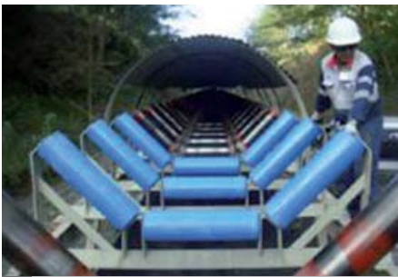
PT Newmonteko irudiak. UCC arrabolen instalazioa 6 km-ko garraiatzailean, zeinak meategia eta tratamendu planta konektatzen dituen; eta aire zabaleko meategiaren ikuspegia.
