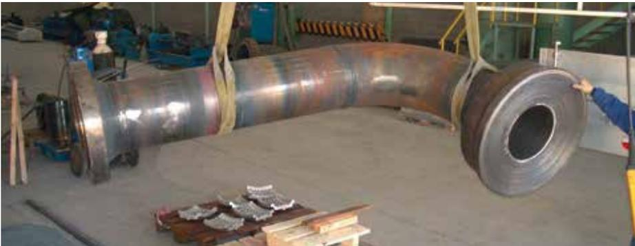
ULMA Piping ha conseguido el primer pedido grande de Spools con recubrimiento de aleación resistente a la corrosión. Un Spool es un elemento a medida
