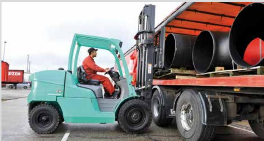
ULMA Carretillas Elevadoras presenta al mercado la renovada FD40-55N de la gama de contrapesadas térmicas GRENDA EX Mitsubishi que incorpora el nuevo motor Perkins 854F, la respuesta de Mitsubishi a la normativa Euro Stage IIIB para motores superiores a 56 Kw (75 HP). Este motor de cuatro cilindros compactos presenta una gran capacidad de respuesta con altos valores de par y densidad de potencia.
